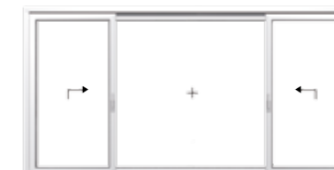
Schema K 2 zdvižno-posuvné krídla, 1 pevné zasklenie
