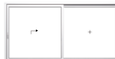
Schema A, ľavé 1 zdvižno-posuvné krídlo, 1 pevné zasklenie
